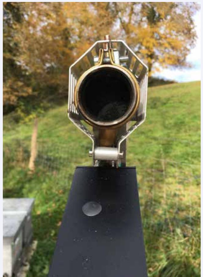
Figure 5. Encrassement de la chambre à combustion d'un sublimox après sublimation d'Api-Bioxal®
