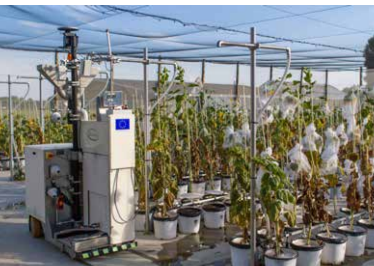
Le robot de la plateforme de phénotypage HeliaPhen à Toulouse contrôle l'irrigation de chaque plante cultivée en pot et effectue plusieurs mesures : développement physiologique, évapotranspiration, photosynthèse, etc. ©INRAE, https://phenotoul.hub.inrae.fr
