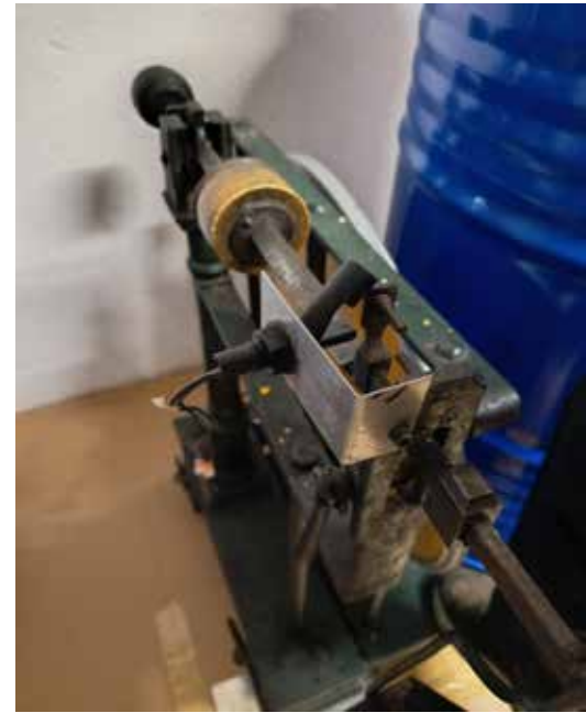
Lorsque le capteur noir est relevé cela signifie que le fût est rempli, le mécanisme stoppe alors la pompe automatiquement
