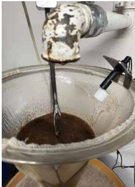
Ce simple capteur blanc placé au niveau du filtre régule le débit et évite des débordements
