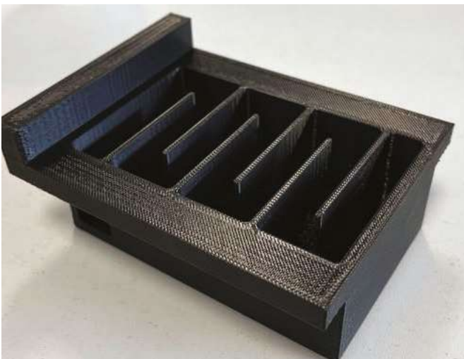
Impression 3D des labyrinthes pour favoriser l'obscurité.
